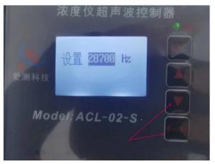
5面板长按△键(3秒)可手动清洗一次,定时结束即停止,自动进入下个循环计时。
